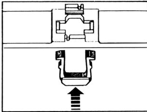
Transparente Halteklemmer von unten in die mittlere Aussparung des Lichteiters einschnappen.
